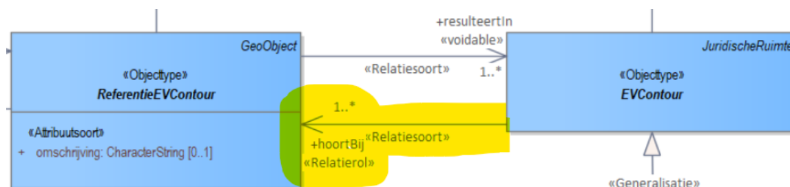
Figuur 29 De relatie-soort die van rechts naar links loopt 'by-reference' maken
